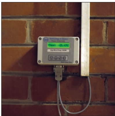
Электронный терморегистратор, подключенный к компьютеру.
