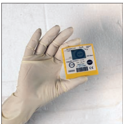
Пример электронного регистратора температуры, используемого во время транспортировки крови.
